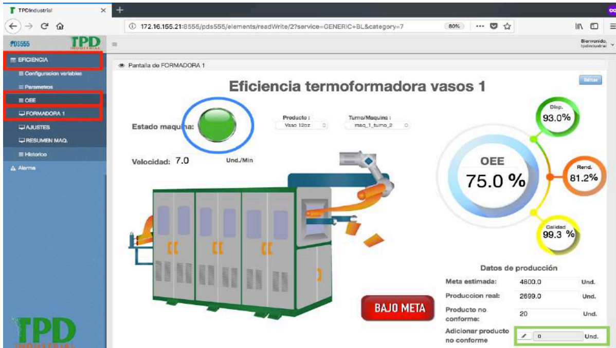
Figure 8: pantalla supervisión maquina
